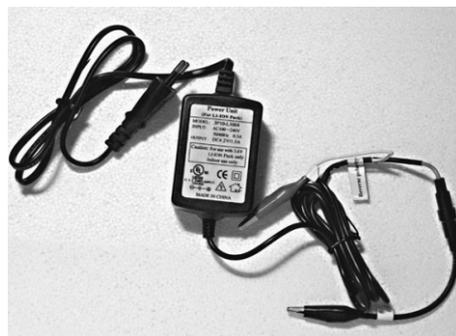
Рис.4 Зарядные устройства для Li-ION и Li-POL аккумуляторных батарей.
