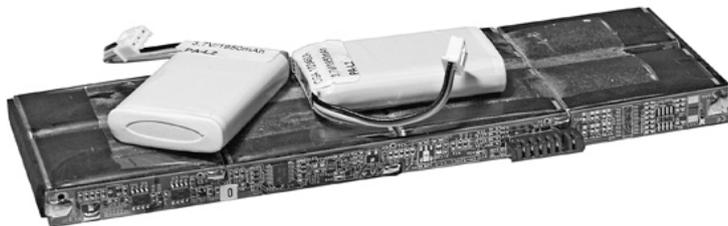
Рис.1 Литий-ионные (Li-ION) и литий-полимерные(Li-POL) аккумуляторные батареи.
