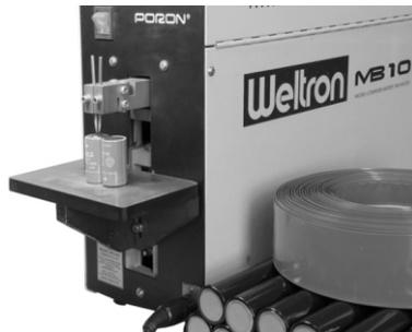
Рис.2 Сварочное оборудование и термоусадочная плёнка для изготовления аккумуляторных батарей.
