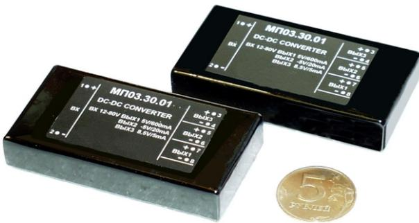
Модуль питания авиационных измерительных приборов.
