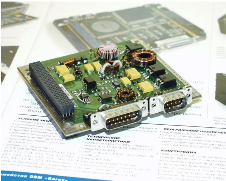
Модуль питания встраиваемой ЭВМ специального назначения «Багет-83» (форм-фактор PC/104).
