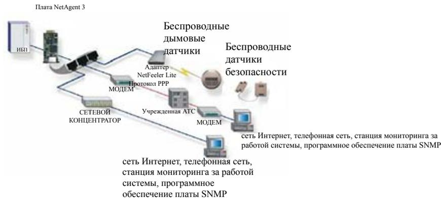
Стандартная топология сетевого управления ИБП.
