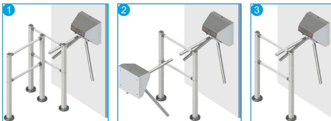
1 2 3 -турникет установлен правильно
