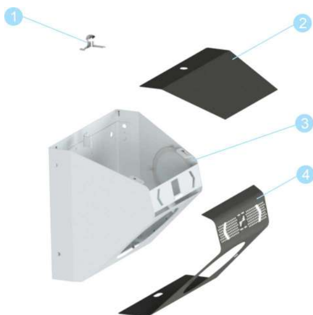
Рисунок 6.1.1. Устройство корпуса турникета
