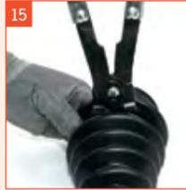
15 Fett an Gelenkkopf einfüllen. Die Spannschelle mit der Spezialzange (Art-Nr. 17988/9) befestigen. Nach Entgasung der Manschette die kleine Schelle festziehen. Wenn eine Schelle beim Spannen verrutscht, diesen Arbeitsgang unter Benutzung der Schellen (Art-Nr. 17988) wiederholen.
