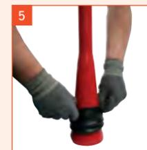
Den Kegel auf den Boden stellen, und die Manschette bis hinter den Absatz schieben.
