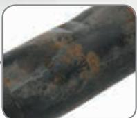
Поврежденный корпус амортизатора
