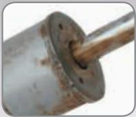
Коррозия на корпусе амортизатора
