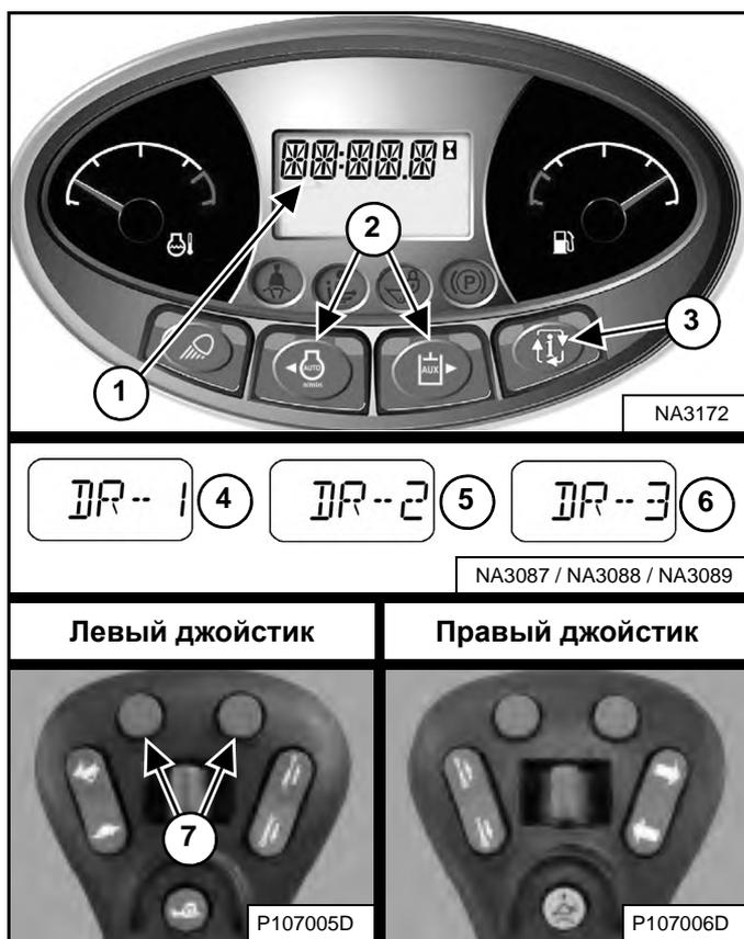
Нажмите кнопку информации (3) для прокрутки информационного дисплея, пока не отобразится меню отклика привода. На дисплее отобразится текущая настройка отклика привода (1) [Рис. 71].
