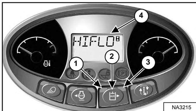
Однократно нажмите кнопку доп. гидравлики (2) для включения доп. гидравлики. Индикатор (1) [Рис. 94] включен.
