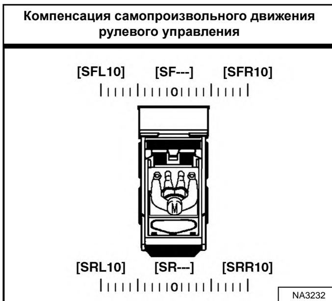
Компенсация самопроизвольного движения рулевого управления имеет 21 настройку. Компенсацию самопроизвольного движения рулевого управления можно установить на любое значение от нейтрального положения до [SFL10] или [SRL10] влево и от нейтрального положения до [SFR10] или [SRR10] вправо. [SF---] или [SR---] отображается при установке в нейтральное положение [Рис. 72].
