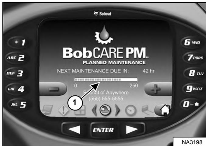
На приборной панели Deluxe (при наличии) будет высвечиваться окно сообщения (1) [Рис. 312] о времени, оставшемся до следующего обслуживания. Если техобслуживание не было произведено вовремя, будет высвечиваться окно красного цвета. [NEXT MAINTENANCE DUE] [(ВРЕМЯ СЛЕДУЮЩЕГО ТЕХОБСЛУЖИВАНИЯ)] изменится на [MAINTENANCE PAST DUE] [(ПРОСРОЧЕННОЕ ВРЕМЯ ТЕХОБСЛУЖИВАНИЯ)], и будет отображаться количество просроченных часов.
