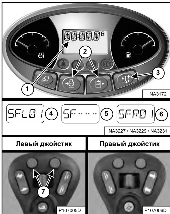
Нажмите кнопку информации (3) для прокрутки информационного дисплея, пока не отобразится меню компенсации самопроизвольного движения рулевого управления. Текущая настройка компенсации самопроизвольного смещения рулевого управления будет отображена на информационном дисплее (1) [Рис. 73].
