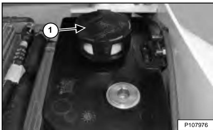
Отверните пробку заливной горловины (1) [Рис. 253].
