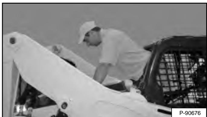
Выйдите через задний проем кабины оператора [Рис. 44].
