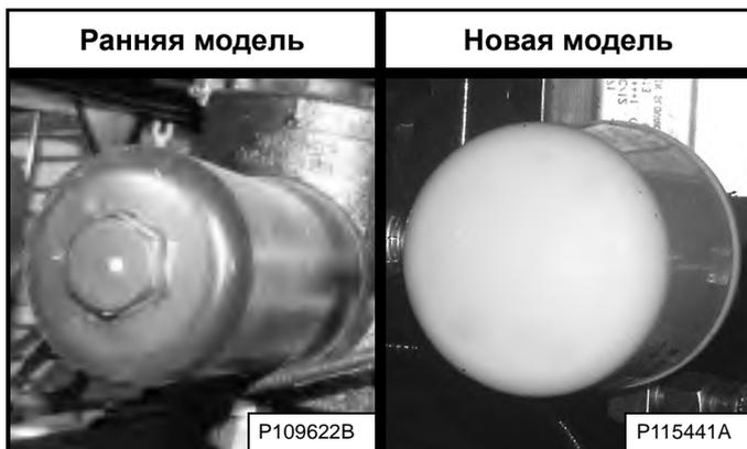
В ранних моделях используется отдельные корпус фильтра и фильтрующий элемент. В новых моделях используется навинчиваемый фильтр [Рис. 263].
