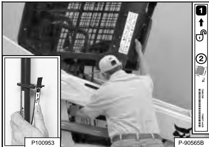
Потяните кабину оператора за нижнюю часть до тех пор, пока ее не остановит фиксирующий механизм [Рис. 199].
