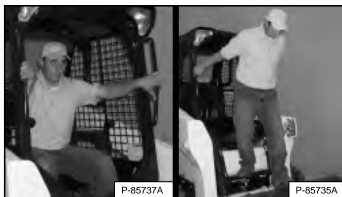
При выходе из кабины пользуйтесь ступеньками, подножками и поручнями (должны обеспечиваться 3 точки опоры) [Рис. 132].
