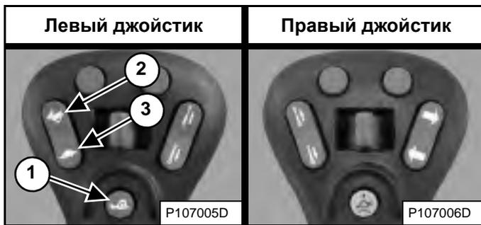
Для включения управления скоростным режимом нажмите кнопку (1) [Рис. 67] на левом джойстике.
