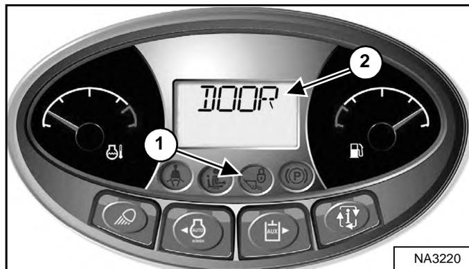
Индикатор LIFT AND TILT VALVE (КЛАПАН ПОДЪЕМА СТРЕЛЫ И НАКЛОНА КОВША) (1) [Рис. 195] ВЫКЛЮЧЕН, когда дверь закрыта, ключ находится в положении RUN (РАБОТА), рама безопасности опущена и кнопка PRESS TO OPERATE LOADER (ВКЛЮЧЕНИЕ ПОГРУЗЧИКА) нажата.
