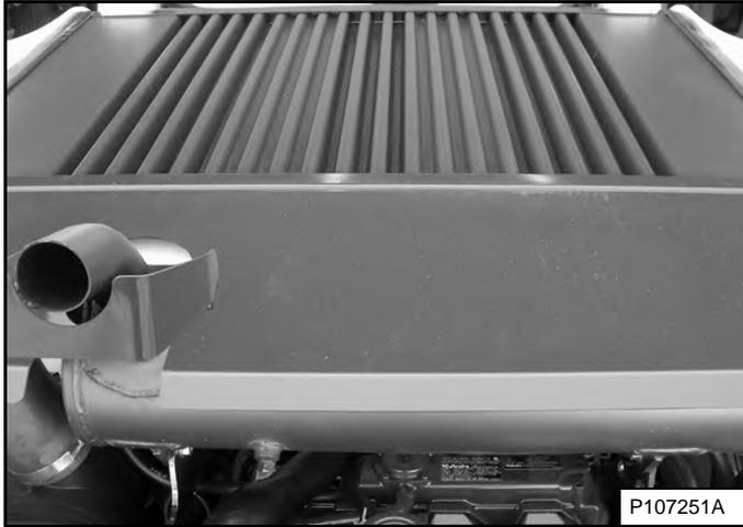
Поднимите заднюю решетку, потяните ее назад и снимите с погрузчика [Рис. 204].
