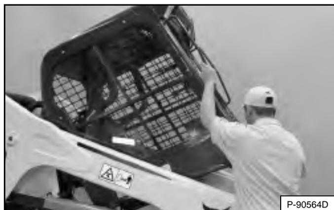
Держась за поручни и низ кабины оператора [Рис. 198], медленно поднимайте ее, пока она не займет крайнее верхнее положение, а фиксирующие механизмы не сработают.
