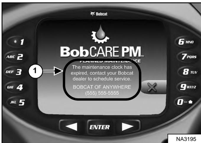
На приборной панели Deluxe (при наличии) будет высвечиваться сообщение (1) [Рис. 311] о необходимости проведения обслуживания машины.
