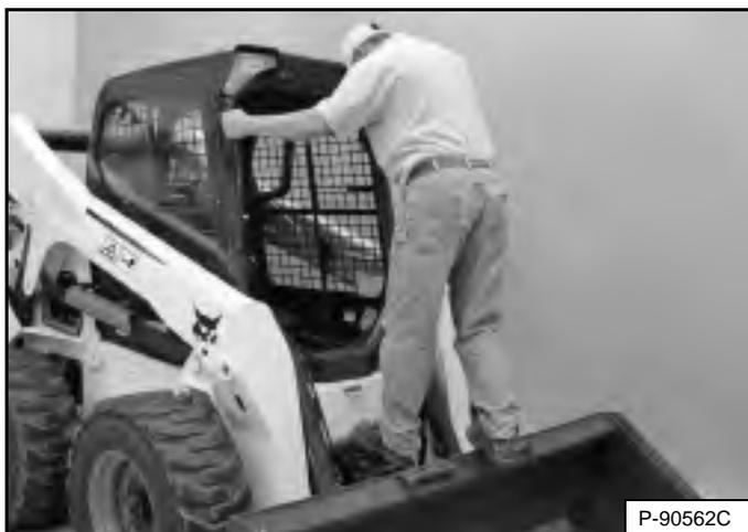
Для подъема на погрузчик и спуска с него используйте ступеньки ковша или навесного оборудования, поручни и подножки (на стреле и раме погрузчика), при этом всегда должны обеспечиваться 3 точки опоры [Рис. 104]. Не выпрыгивайте из кабины.
