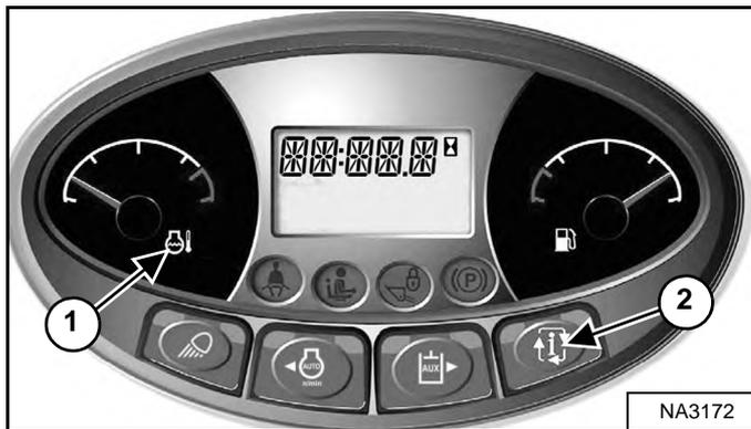
Регулярно проверяйте датчики температуры и уровня топлива и индикаторы системы BICS (для работы погрузчика все индикаторы BICS™ должны быть выключены) [Рис. 129].
