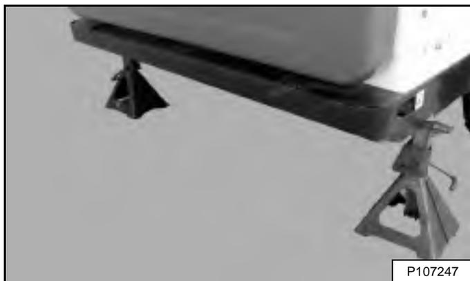
Установите подставки-опоры под заднюю часть рамы погрузчика [Рис. 196].
