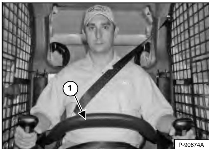
Система блокировки управления Bobcat (BICS™) состоит из подвижного защитного ограждения сиденья с подлокотниками (1) [Рис. 34]. Оператор может менять положение рамы безопасности.
