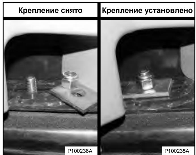
Установите на место шайбы и гайки (с обеих сторон) [Рис. 200].
