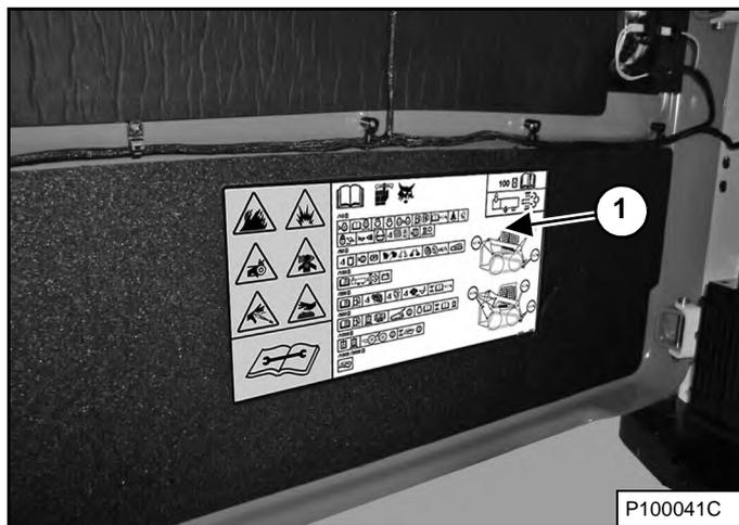
Контрольный лист и график обслуживания (1) [Рис. 103] расположен на внутренней стороне задней крышки погрузчика.
