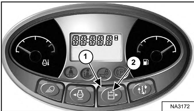
Однократно нажмите кнопку доп. гидравлики (2) [Рис. 85] для включения доп. гидравлики.
