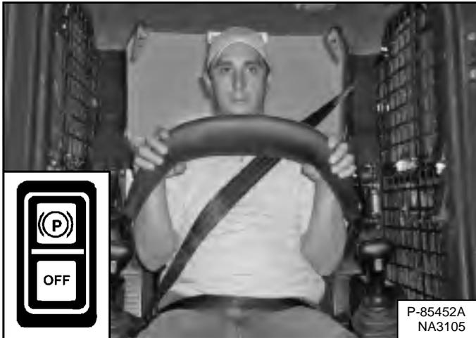
Опустите раму безопасности и включите стояночный тормоз [Рис. 112].
