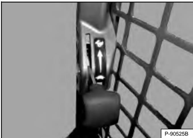
Установите рычаг управления оборотами двигателя в положение низких оборотов холостого хода [Рис. 119].
