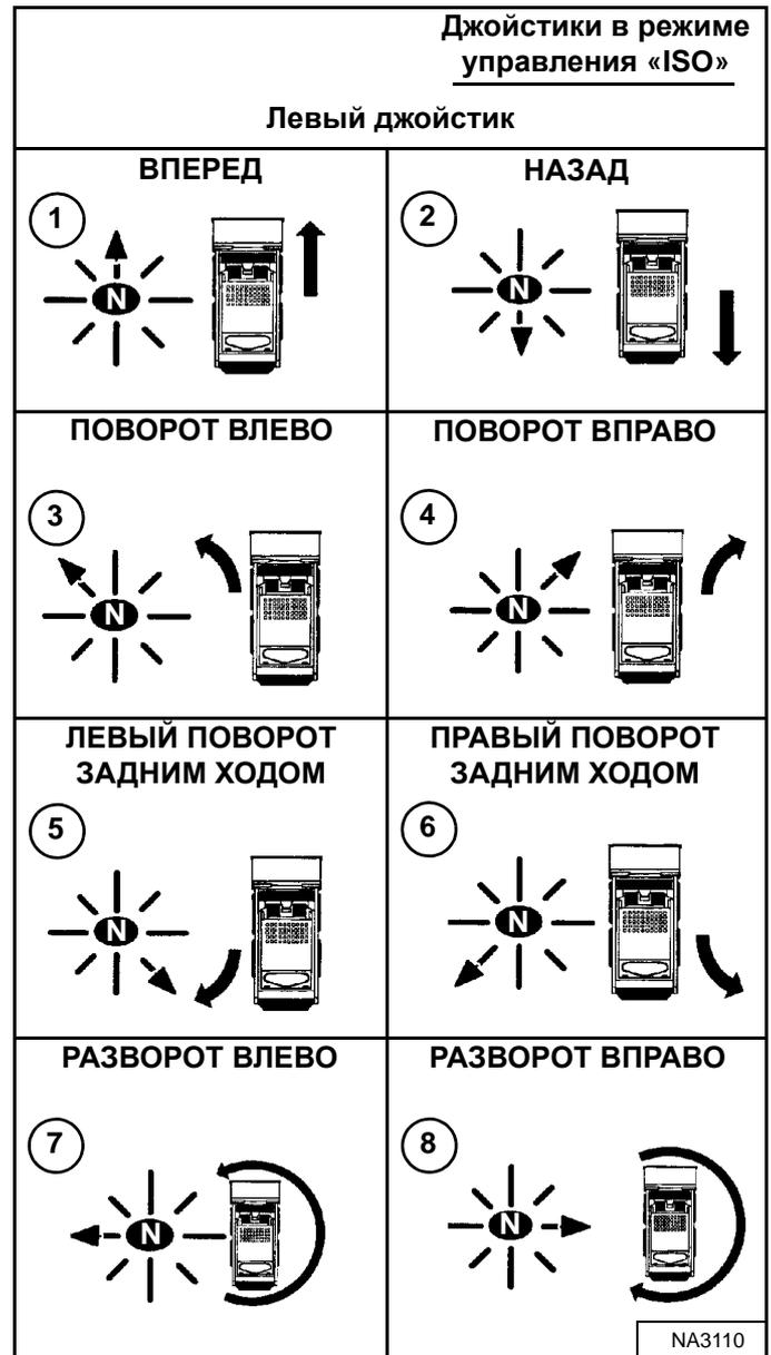
Функции левого джойстика (движение и маневрирование) [Рис. 60]:
