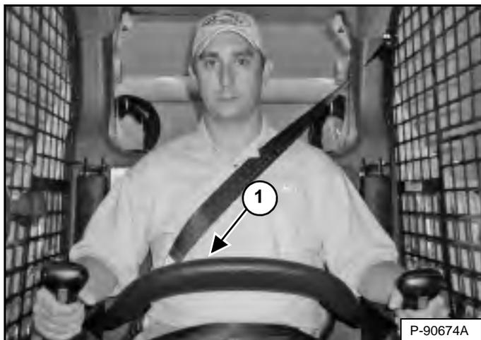
Система блокировки (рама безопасности) состоит из подвижного защитного ограждения сиденья с подлокотниками (1) [Рис. 181].
