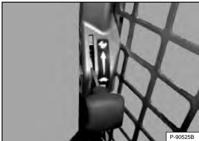
Установите рычаг управления оборотами двигателя в положение низких оборотов холостого хода [Рис. 130].
