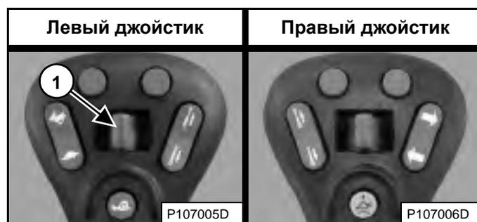
Несколько раз переместите переключатель задней дополнительной гидравлики (1) [Рис. 97] или [Рис. 98] влево и вправо. Поверните ключ в положение STOP (СТОП).
