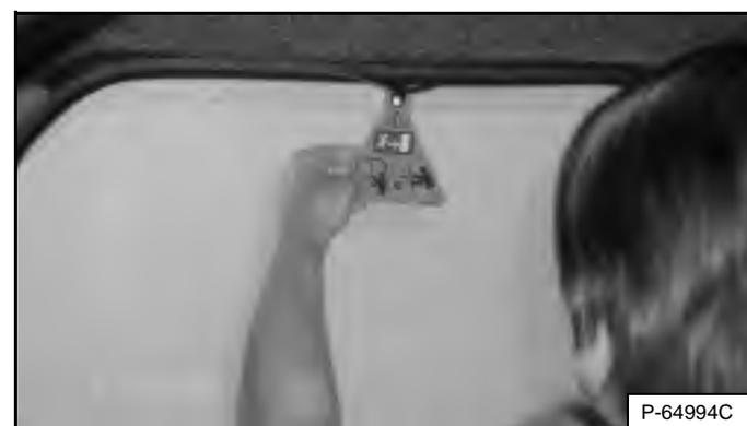
Потяните за язычок, расположенный в верхней части заднего окна, чтобы вынуть резиновый уплотнитель [Рис. 45].
