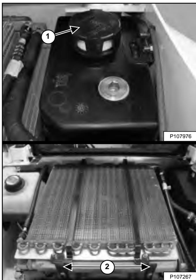
Удалите пробку заливной горловины гидравлической системы (1) [Рис. 255].
