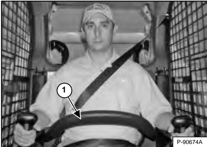
Система блокировки (рама безопасности) состоит из подвижного защитного ограждения сиденья с подлокотниками (1) [Рис. 36].
