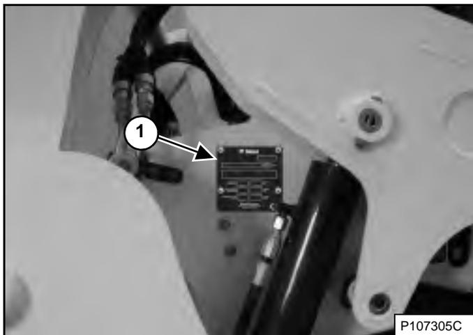
Табличка с серийным номером погрузчика (1) [Рис. 1] расположена на внешней стороне рамы погрузчика.
