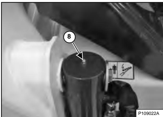
8. Торце основания цилиндра наклона ковша (с обеих сторон) (2) [Рис. 295].
