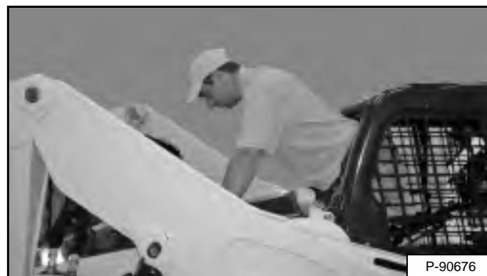
Выйдите через задний проем кабины оператора [Рис. 46].
