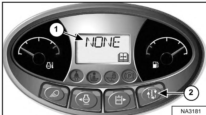
Нажмите кнопку ИНФОРМАЦИЯ (2) для прокрутки ДИСПЛЕЯ ДАННЫХ (1), [Рис. 306] пока не отобразится экран служебных кодов. Если служебных несколько, то они будут отображаться на дисплее данных один за другим.
