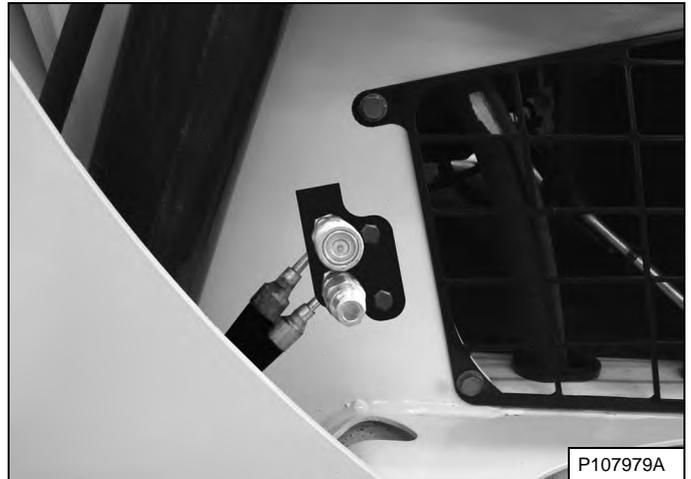
Переместите переключатель передней доп. гидравлики (1) [Рис. 91] или [Рис. 92] вправо или влево для изменения направления подачи масла в быстроразъемные муфты передней доп. гидравлики [Рис. 93]. (ПРИМЕР: подъем и опускание задних стабилизаторов.) Отпустите переключатель, чтобы выключить подачу масла.
