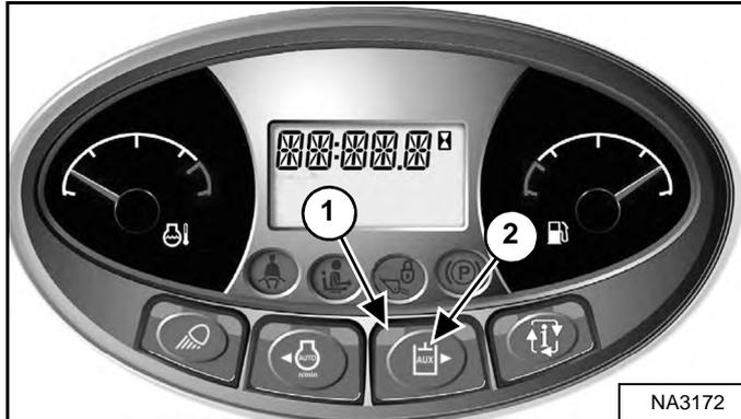
Однократно нажмите кнопку доп. гидравлики (2) [Рис. 90] для включения доп. гидравлики.
