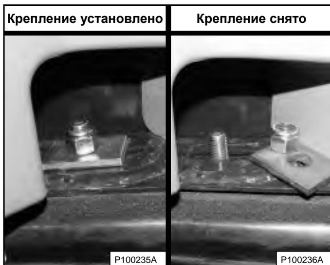
Отверните гайки и шайбы [Рис. 197], которые находятся в передних углах кабины оператора с обеих сторон.
