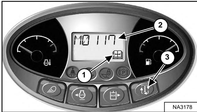
Заменяйте воздушные фильтры только по мере необходимости. Служебный индикатор (1) будет МИГАТЬ. Нажмите кнопку информации (3), удерживая ее до тех пор, пока на экране дисплея не отобразятся служебные коды. Служебный код **[M0117]** (Засорен воздушный фильтр) отобразится на дисплее (2) [Рис. 215] при необходимости замены воздушного фильтра.
