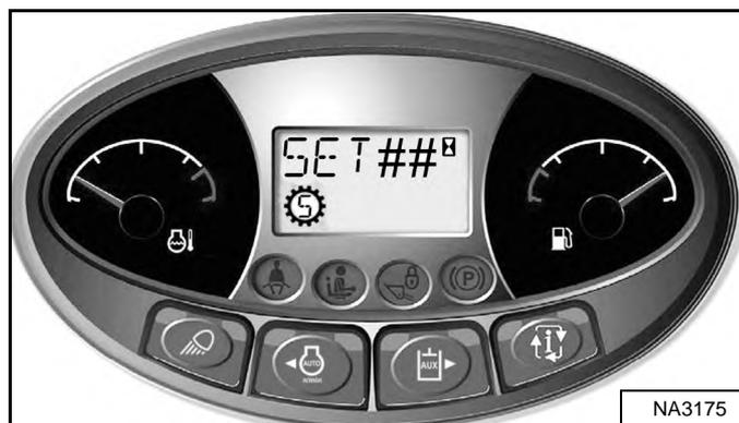
Звуковой сигнал прозвучит один раз, на дисплее отобразится [SET ##] (УСТАНОВЛЕНО ##) [Рис. 70] (## – выбранное процентное значение), а устройство продолжит работу в режиме управления скоростным режимом.
