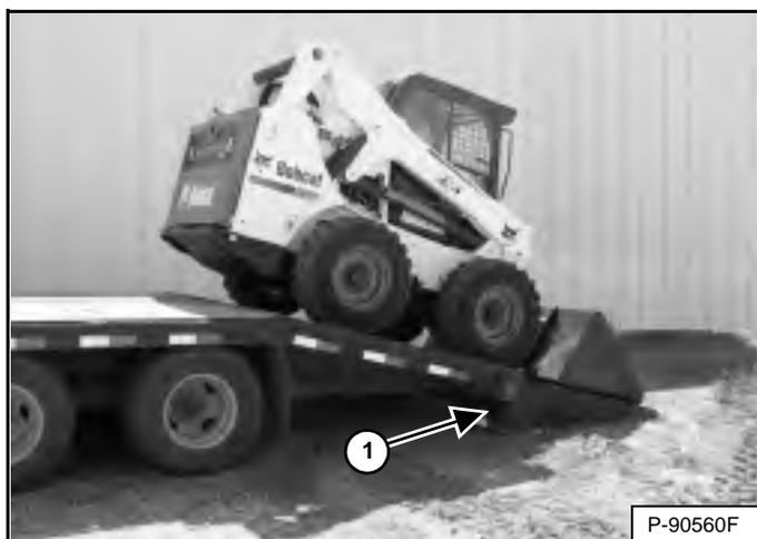
Погрузчик с пустым ковшом или со снятым навесным оборудованием грузится на транспортную платформу, двигаясь задним ходом [Рис. 178].
