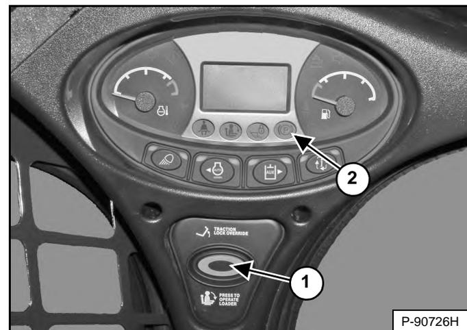
*(Работает только при поднятой раме безопасности и работающем двигателе)* На левой приборной панели имеется кнопка TRACTION LOCK OVERRIDE (УПРАВЛЕНИЕ ПРИ БЛОКИРОВКЕ ТЯГИ) (1) [Рис. 38], которая позволяет использовать рычаги управления движением для перемещения погрузчика вперед и назад при использовании обратной лопаты.
