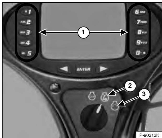
Поверните ключ в положение RUN (РАБОТА) (2) [Рис. 125]. Индикаторы на левой приборной панели загорятся на короткое время, и приборная панель и система контроля работы погрузчика выполнят самопроверку.
