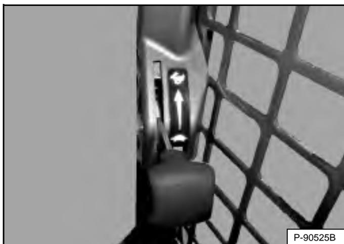
Установите рычаг управления оборотами двигателя в положение низких оборотов холостого хода [Рис. 124].
