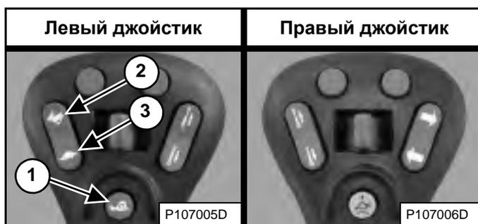
Установить более высокое (2) или более низкое (3) значение скорости [Рис. 69] можно, нажимая переключатель скоростей до достижения нужного значения.
