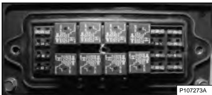
Для проверки или замены предохранителей и реле снимите крышку панели предохранителей [Рис. 246].
