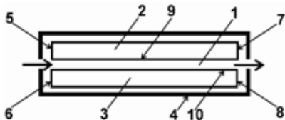
Рис. 3. Волновод для создания эффекта радиационной сверхтекучести рентгеновского излучения: 1 – зазор; 2, 3 – стенки рефлекторов; 4 – волновод; 5, 6, 7, 8 – торцы; 9, 10 – поверхности стенок
