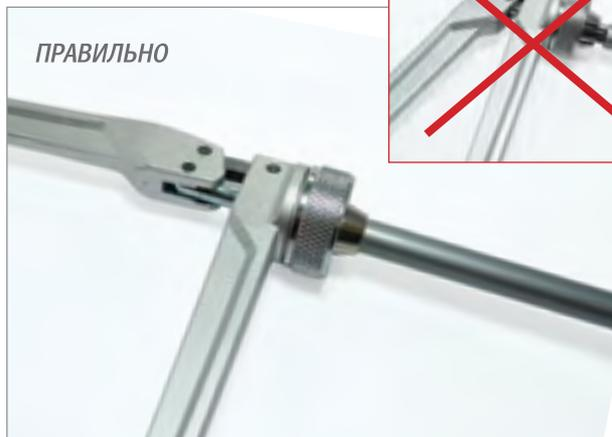
Для выполнения расширения необходимо медленно и равномерно сжать инструмент до упора.
