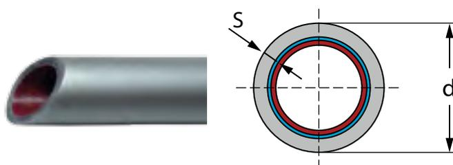
Многослойная труба КОНТУР G-RAY OXY PERT-EVOH-PERT изготовлена из полиэтилена повышенной термостойкости PE-RT II по ТУ 2248-016-14504968-2014, имеет кислородо-непроницаемый слой EVOH (этилвиниловый спирт), что позволяет использовать трубу в системах радиаторного отопления, класс применения 5 по ГОСТ 32415-2013, соединяется подвижными гильзами.
