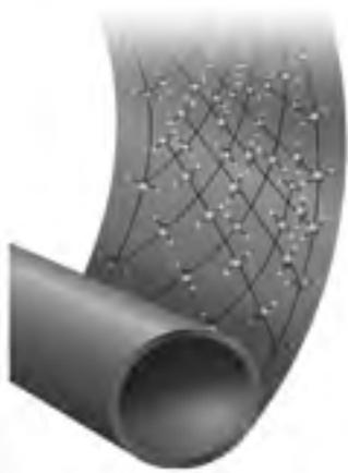
*Кристаллическая микроструктура компаунда термостойкого полиэтилена PE-RT*
