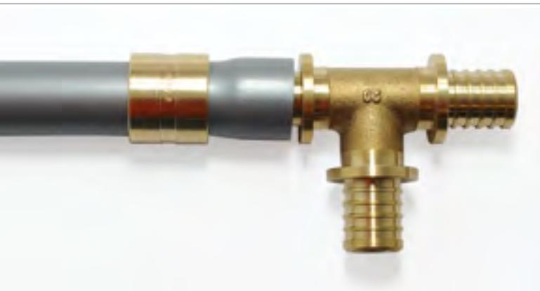
С помощью пресс-инструмента надвигаем гильзу до буртика фитинга. Необходимо следить за тем, чтобы обжимные головки были установлены в фитинге так, чтобы опрессовка производилась без перекоса и по возможности за один прием.
