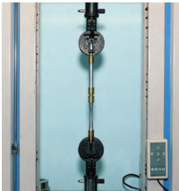
**Контроль фитингов** из латуни и других материалов включает: геометрический контроль, проверку механических характеристик (предел прочности при сжатии).
