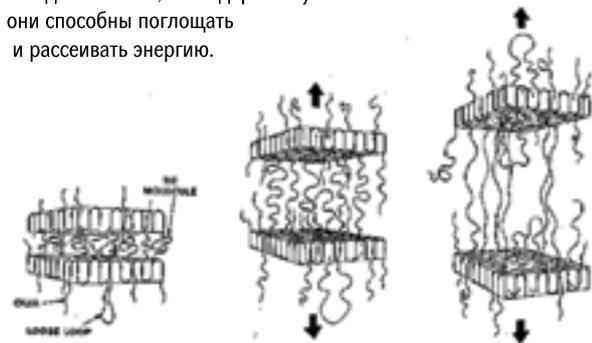
Стадии вязкой деформации полиэтилена PE-RT
