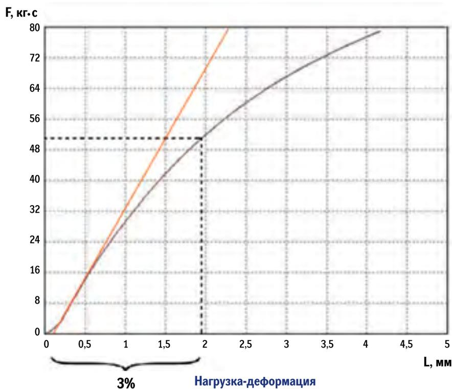
где **F** – сила,  $[\text{кг} \cdot \text{с}]$ , соответствующая относительному укорочению вертикального диаметра кольцевого образца на 3%;
