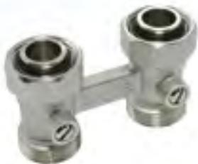
Н-образный прямой запорный узел предназначен для подключения к отопительному прибору (радиатору) с нижним подключением. Материал: латунь. Рабочая среда: холодная/горячая вода от 0°C до +120°C. Условное давление(PN)-1,6 МПа.
