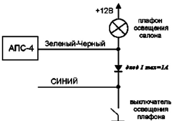
2. Рекомендуемая схема подключения СИНЕГО провода системы ("отрицательный триггер двери") к проводке автомобилей ВАЗ семейств 2110 и 2115, оснащенных иммобилайзерами АПС-4:
