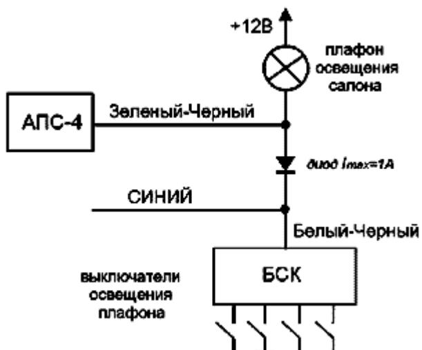
3. Рекомендуемая схема подключения КОРИЧНЕВОГО провода системы ("отрицательный триггер капота/багажника") к подкапотной лампе автомобилей ВАЗ семейств 2109, 2115, 2123 или лампе освещения багажника автомобилей ВАЗ семейства 2115:
