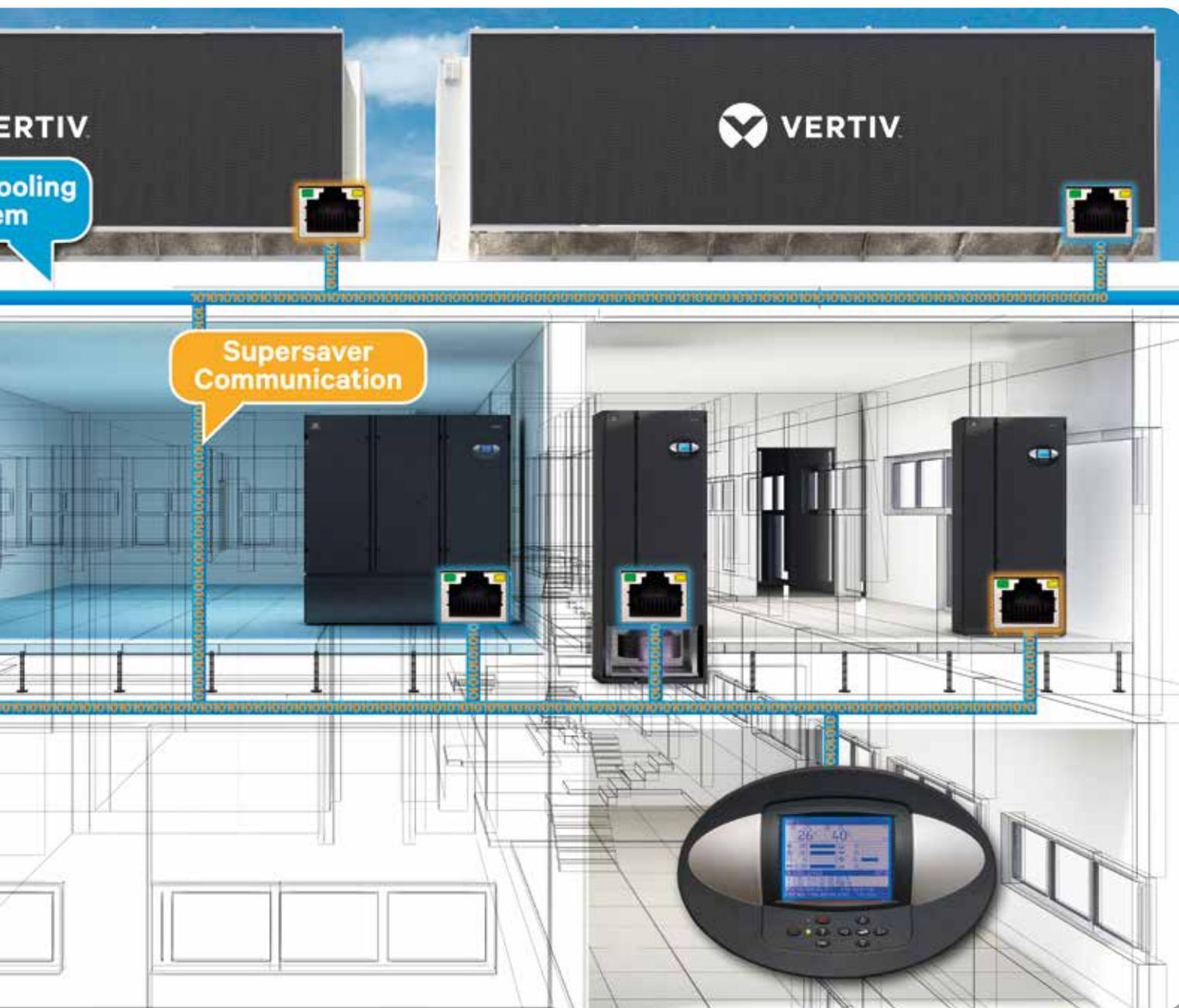
в одном помещении благодаря интегрированному Ethernet-соединению. Самоконтроль резервных блоков обеспечивает поочередный переход в режим ожидания и приоритетное охлаждение «горячих» точек. Общий контроль нескольких устройств позволяет им работать вместе как единой системе,
