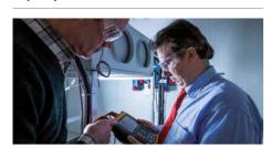
Вторая зона заводских испытаний подразделения исследований и разработок предназначена для кондиционеров телекоммуникационного сектора; в нее входят две камеры для проведения испытаний: одна для моделирования температуры воздуха внутри помещения в диапазоне от 0 до 60 °C и вторая для моделирования температуры воздуха вне помещения в диапазоне от -32 до 60 °C. Баланс температурной нагрузки можно установить в пределах до 100 кВт (по 50 кВт на каждое помещение).
