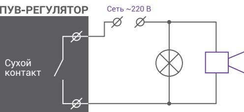
Схема подключения внешнего устройства для подачи звукового (светового) сигнала.
