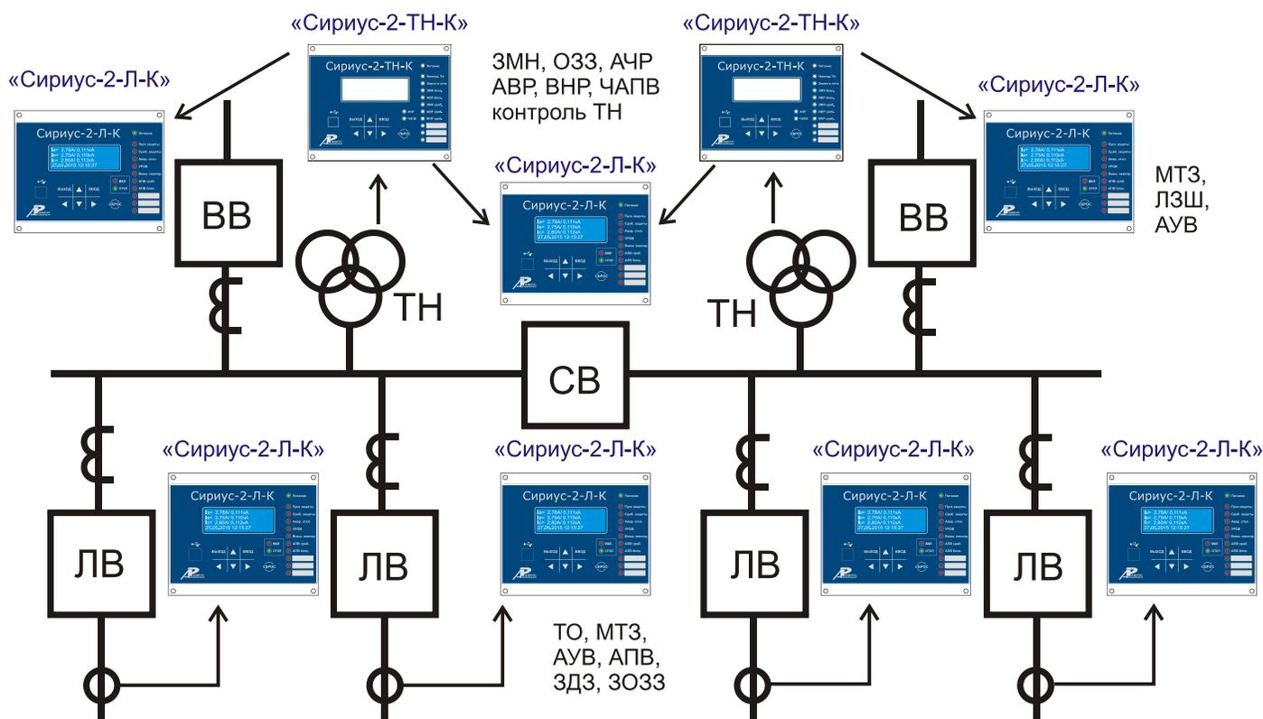
На приведенной схеме показан пример построения системы РЗА повышенной экономической эффективности для РП с совместным применением «Реле тока Сириус-2-Л-К» и «Реле напряжения Сириус-2-ТН-К» производства ЗАО «РАДИУС Автоматика».
