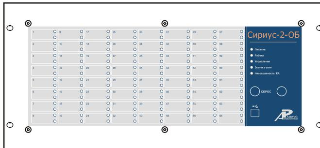
Кроме этого, за счет наличия двух сигналов от каждого КА, устройство осуществляет непрерывную диагностику состояния этих сигналов, и в случае получения запрещенных комбинаций этих двух сигналов (оба одновременно отсутствуют или присутствуют) выдает сигнализацию неисправности с указанием конкретного неисправного КА на световом табло передней панели устройства.
