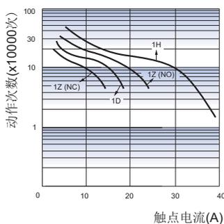
测试条件: 阻性负载, AgCdO, 防尘罩型, 室温, 1s通9s断。
