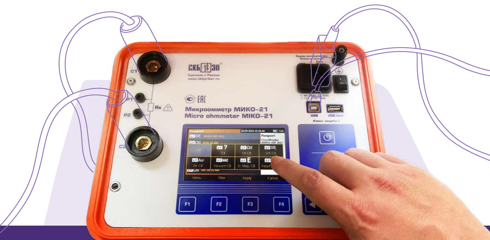
Область применения: для применения на высоковольтных подстанциях и в промышленных условиях
