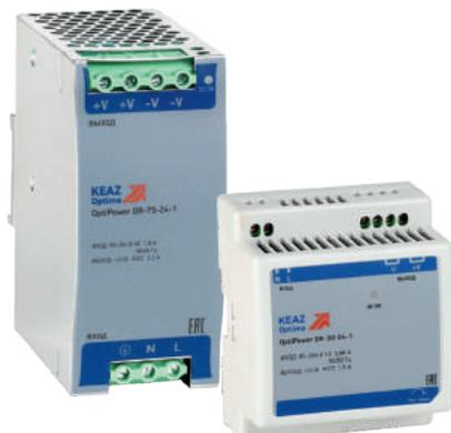
Универсальные однофазные блоки питания OptiPower серий DR и MDR являются импульсными AC/DC преобразователями напряжения с креплением на DIN-рейку, обеспечивают питание различных устройств автоматики стабилизированным напряжением постоянного тока 24 В и защиту от перегрузки, перенапряжения и короткого замыкания на выходе.
