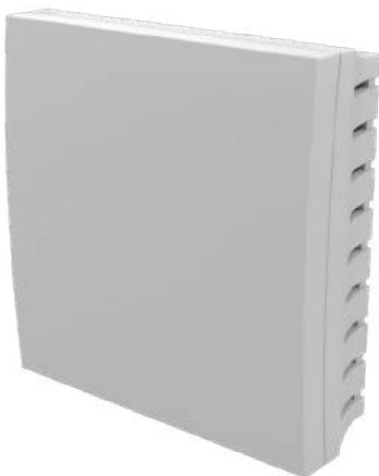
Датчики температуры OptiSensor RTF1 выпускаются в корпусе из ABS-пластика с защелкивающейся крышкой и предназначены для измерения температуры воздуха в зданиях. Устанавливаются как на стену, так и в монтажном коробе или распределительной коробке.
