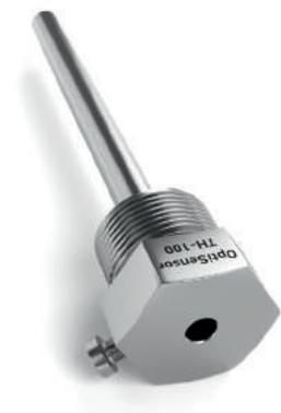
Предназначены для защиты от высокого давления, агрессивной среды и высокой скорости потока, а также отделяют датчик температуры от измеряемой среды, в связи с чем возможно производить монтаж и замену термометра без остановки процесса. Применение OptiSensor TH позволяет использовать датчики температуры в трубопроводах и резервуарах с избыточным давлением до 4 МПа.
