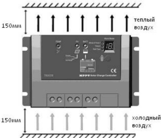
*Рис.2. Установка контроллера*
