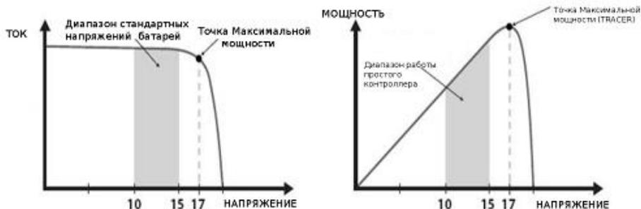
Рис.4. Зависимость силы тока от напряжения для систем с 12-вольтовым номиналом ( I-V)
