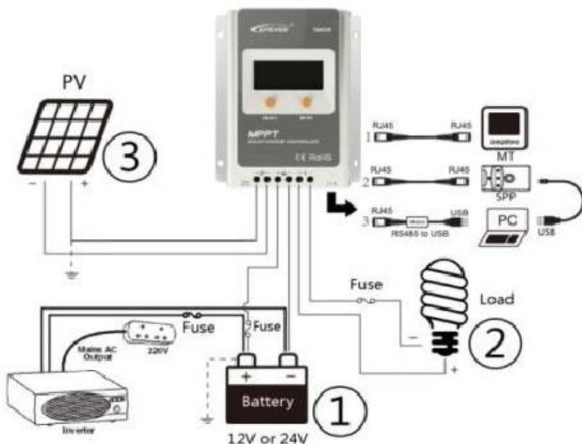
Рис.3. Общая схема подключения контроллера и установка предохранителей
