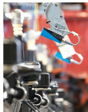
汽车装配中的部件检查和尺寸测量
