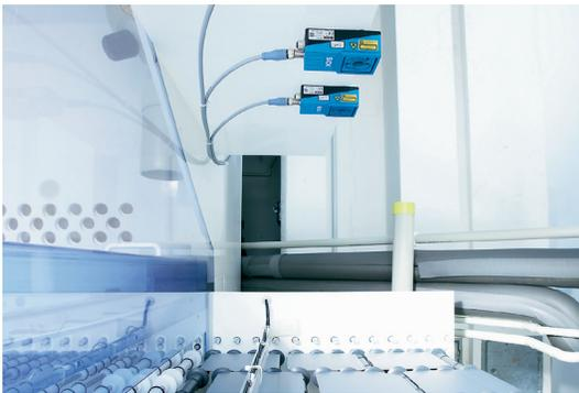
太阳能硅晶片边缘破损检测
