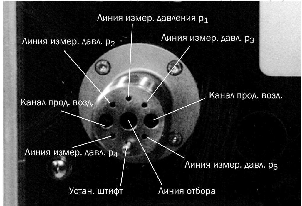
Рис. 31: Соединительная деталь на блоке управления для подключения устройства отбора проб
