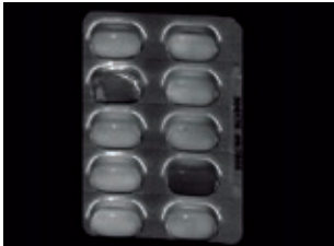
激光散射图像 用于检测空的吸塑包装
