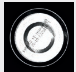
使用红色滤光片的圆顶光照明
