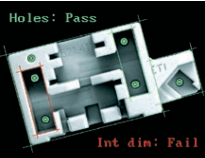
尺寸控制 IVC-2D可借助标定和测量工具精确测量边缘、孔洞或者其他特征之间的尺寸。
