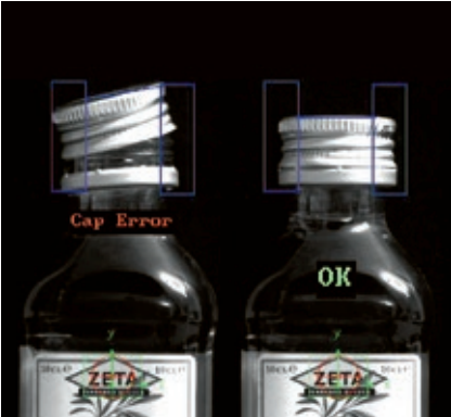
多重检测 IVC-2D配备灵活的软件，可同时检测多个特征，如瓶盖倾斜度、填充高度和标签位置。
