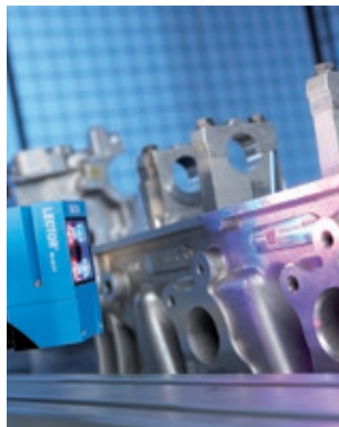
识别发动机组，可实现独立的生产控制和追踪
