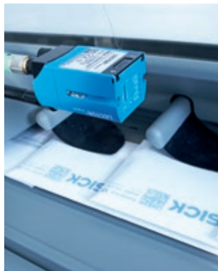
读取高速印刷机和分类机上的条码
