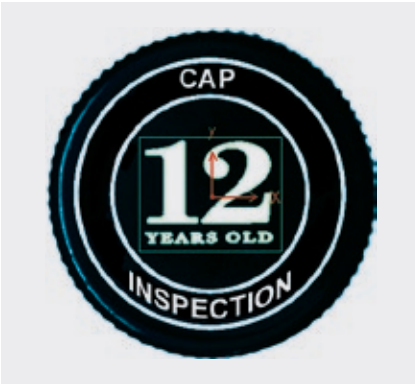
瓶盖检测 IVC-2D采用先进的图案匹配算法，可快速定位和精确检测印有内容的瓶盖，同时检查印刷位置和质量。
