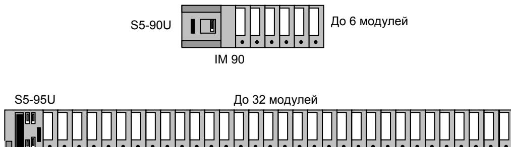
С помощью модуля IM 90 к контроллеру S5-90U может быть подключено до 6 модулей ввода-вывода серии S5-100U. Контроллер S5-95U допускает непосредственное подключение до 32 таких модулей.
