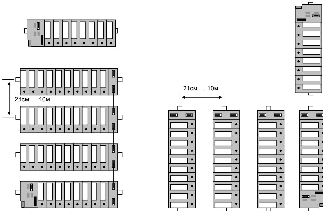
В горизонтальной конфигурации модули устанавливаются один рядом с другим на горизонтальной профильнойшине (одноуровневая конфигурация). Если длины одной профильной шины не достаточно для размещения всех модулей, шины могут быть расположены на нескольких уровнях (до 4-х). Для обеспечения необходимого теплового режима минимальное расстояние между профильными шинами должно быть равным 21см. Максимальное расстояние между шинами может достигать 10м.
