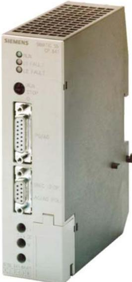
Коммуникационный процессор CP 541 предназначен для подключения контроллеров S5-90U, S5-95U, S5-95F, S5-100U, S5-115U, S5-115F и S5-115H к сети PROFIBUS. Такое подключение позволяет производить обмен данными между всеми контроллерами семейства SIMATIC, включая контроллеры семейств S7/C7.
