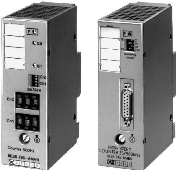
Счетчики 385A и 385B позволяют разгрузить центральный процессор контроллера от выполнения счетных задач. Модули могут использоваться в составе контроллеров S5-90U, S5-95U, S5-95F и S5-100U. Модуль 385B может дополнительно применяться в программируемых контроллерах S5-95F.
