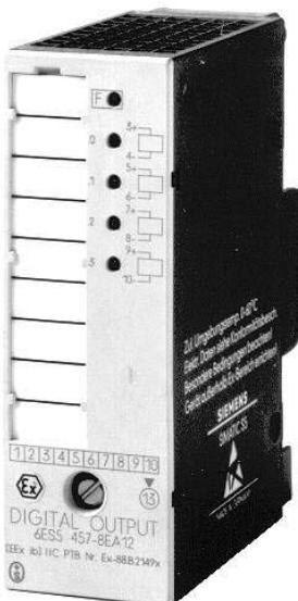
Ex модули вывода дискретных сигналов предназначены для преобразования внутренних логических сигналов контроллера во внешние дискретные выходные сигналы управления исполнительными механизмами, расположенные в зонах повышенной опасности.
