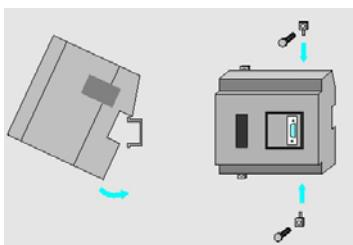
Контроллеры S5-90U и S5-95U монтируются на 35мм профильную шину DIN. Кроме того, контроллер S5-90U может монтироваться на плоских поверхностях с помощью 4-х винтов M5.
