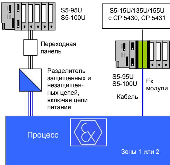
Ex модули предназначены для подключения оборудования, установленного в зонах повышенной опасности. Они обеспечивают разделение и согласование внешних искробезопасных цепей с внутренними незащищенными цепями контроллера.
