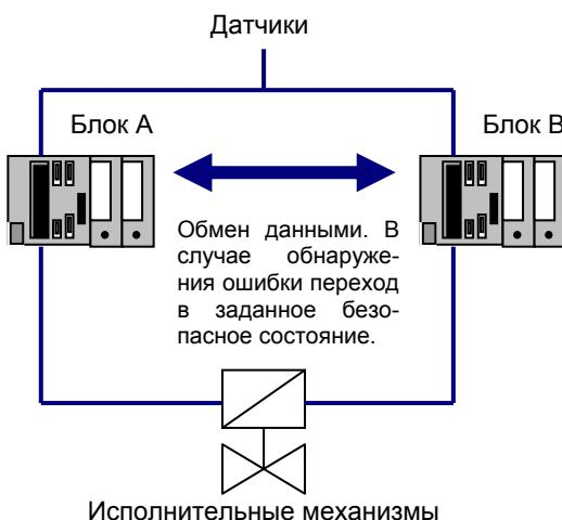
Принцип действия программируемого логического контроллера S5-95F определяется взаимодействием центрального процессора с программой, а также связью между его блоками. Работа системы, построенной на основе S5-95F возможна лишь тогда, когда в исправном состоянии находятся оба его блока.
