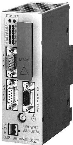
IP 265 является скоростным свободно программируемым модулем, который способен разгрузить центральный процессор от выполнения задач управления, предъявляющих жесткие требования к скорости обработки информации. Модуль может использоваться в составе систем, построенных на основе контроллеров S5-90U, S5-95U и S5-100U.
