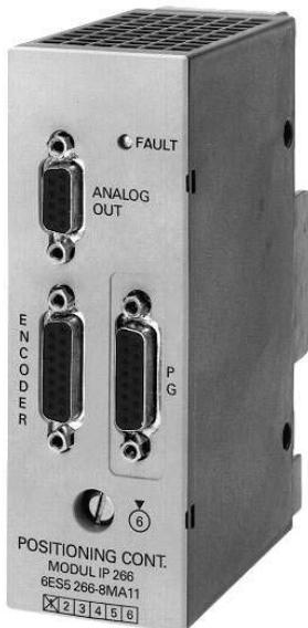
Модуль IP 266 используется для позиционирования электроприводов переменной скорости с серводвигателями, осуществляющими линейное и угловое перемещение. Задачи управления позиционированием выполняются автономно. Настройка параметров модуля выполняется с помощью программного обеспечения СОМ 266. Данные сохраняются в памяти центрального процессора, откуда могут загружаться в модуль IP 266.
