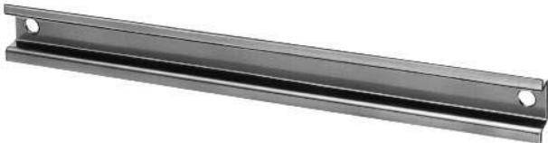
35мм профильные шины DIN отвечают требованиям стандарта EN 50 022 и используются для установки модулей программируемых контроллеров S5-90U, S5-95U, S5-95F, S5-100U.
