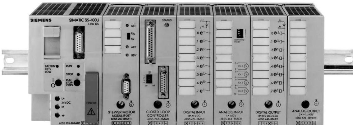
Программируемый контроллер SIMATIC S5-100U предназначен для решения широкого круга задач автоматического управления и имеет модульную конструкцию. Большой набор модулей ввода-вывода, интеллектуальных модулей и коммуникационных процессоров позволяет выбирать оптимальную конфигурацию контроллера применительно к требуемому варианту его использования.
