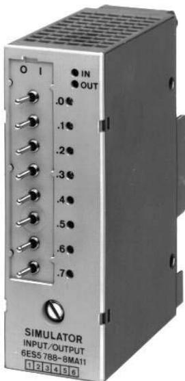
Модуль 788 используется для отладки программ пользователя. Он позволяет имитировать входные дискретные сигналы контроллера и индицировать значения его выходных дискретных сигналов с помощью встроенных светодиодов. Дополнительный источник питания для работы модуля не нужен.
