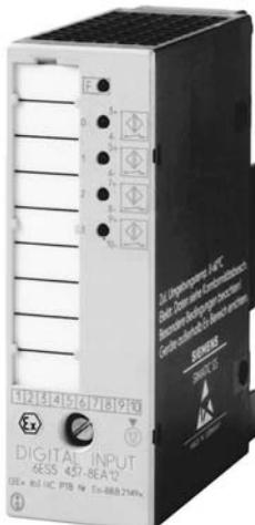
Ex модули ввода дискретных сигналов предназначены для приема дискретных сигналов от датчиков, размещенных в зонах повышенной опасности, и преобразования этих сигналов во внутренние логические сигналы контроллера. К входам Ex модулей могут подключаться датчики, соответствующие требованиям DIN 19 234 (NAMUR).
