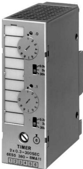
Модуль 380 объединяет два таймера. Грубая настройка требуемых выдержек времени производится с помощью переключателей, расположенных на фронтальной панели модуля. Точная регулировка выдержки времени выполняется потенциометрами. Запуск таймеров производится по сигналам центрального процессора или контроллера более высокого уровня. Окончание отсчета заданной выдержки времени сопровождается посылкой сигнала в центральный процессор контроллера.
