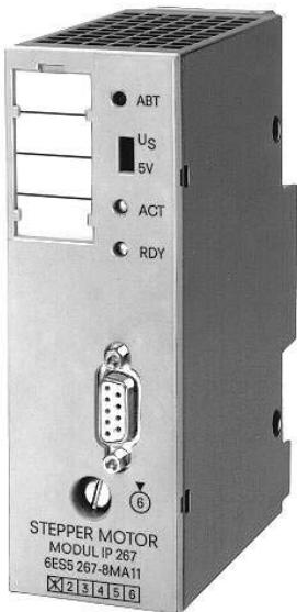
Модуль IP 267 используется для позиционирования электроприводов с шаговыми двигателями. Специального программного обеспечения для настройки параметров модуля не требуется. Модуль может использоваться в программируемых контроллерах S5-90U, S5-95U и S5-100U.
