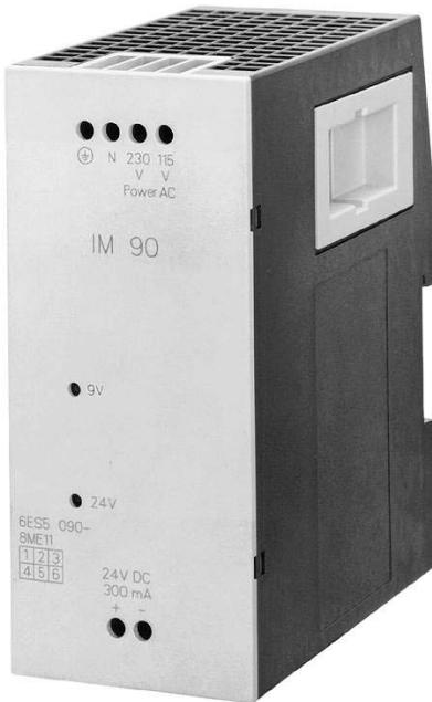
Интерфейсный модуль IM 90 используется в программируемых контроллерах S5-90U и позволяет производить подключение к одному контроллеру до 6 модулей ввода-вывода серии S5-100U. Модуль устанавливается на 35мм профильную шину DIN вместе с контроллером S5-90U и шинными соединителями для установки модулей ввода-вывода.
