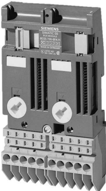
Внутренняя шина программируемого контроллера S5-100U формируется из шинных соединителей. Аналогичным образом формируются и шины расширения контроллеров S5-90U, S5-95U, S5-95F. Соединители устанавливаются непосредственно на 35мм профильную шину DIN и соединяются между собой плоскими кабелями с цветной маркировкой жил.
