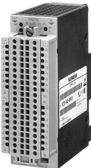
Модуль оснащен 16 дискретными входами и 16 дискретными выходами. Входные каскады модуля выполняют преобразование входных дискретных сигналов контроллера в его внутренние логические сигналы. Выходные каскады обеспечивают преобразование внутренних логических сигналов контроллера в его выходные дискретные сигналы.
