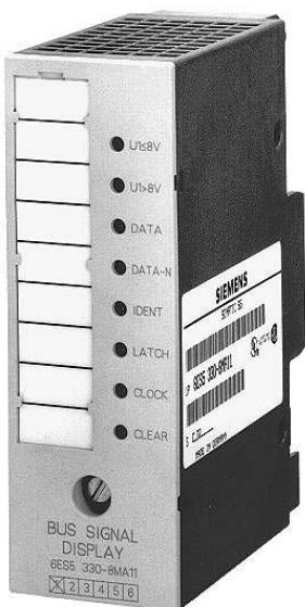
Модуль 330 позволяет выполнять мониторинг шины ввода-вывода программируемых контроллеров S5-90U, S5-95U и S5-100U. Он позволяет идентифицировать отказы модулей ввода-вывода, фиксировать чрезмерно высокую нагрузку шины, определять места повреждения соединительных линий, выявлять неисправные шинные соединители.
