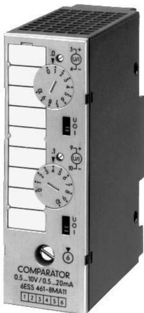
Модуль 461 объединяет два компаратора. Каждый компаратор производит сравнение внешних аналоговых сигналов с заданными пороговыми значениями. При выходе аналогового сигнала за пороговые значения модуль формирует сигнал для центрального процессора или для контроллера более высокого уровня.
