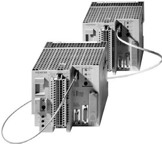
Резервированный контроллер S5-95F/P предназначен для построения систем безопасного управления прессами и состоит из двух одинаковых блоков, соединенных оптоволоконным кабелем. Для расширения системы ввода-вывода допускается применение модулей 6ES5431-8FA11 и 6ES5450-8FA12.
