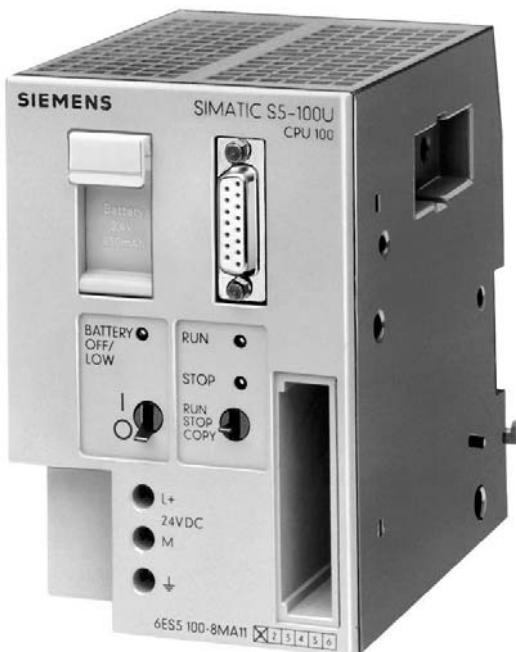
Программируемые контроллеры S5-100U могут комплектоваться тремя типами центральных процессоров. Эти центральные процессоры отличаются объемами встроенной памяти, быстродействием, возможностями расширения, набором команд и т.д.
