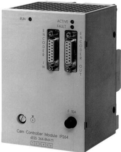
Быстродействующий модуль IP 264 является электронным аналогом кулачкового командоконтроллера. Он применяется для управления вращательным или линейным перемещением электроприводов.
