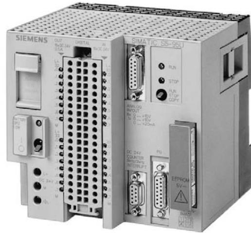
Программируемые контроллеры S5-90U и S5-95U выпускаются в пластиковых корпусах и объединяют в своем составе центральный процессор, блок питания, встроенные входы и выходы. Корпуса крепятся на 35мм профильную шину DIN.
