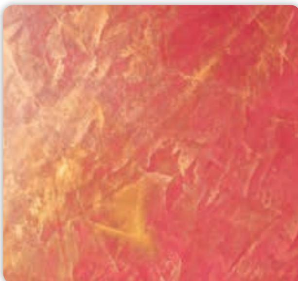
**Эффект штукатурки с блеском** - Для получения блестящей поверхности, как основа наносится три слоя Grassello di calce. Выравнивать, добиваясь гладкой и однородной поверхности. На высохшую и отполированную основу наносят кельмой тонкий слой Cadoro база золото или Abc riflessi.
