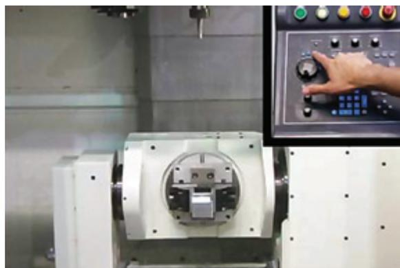
Затем просто нажмите две кнопки и цикл обработки автоматически возобновится точно там, где он был прерван с выбранной Вами скоростью.
